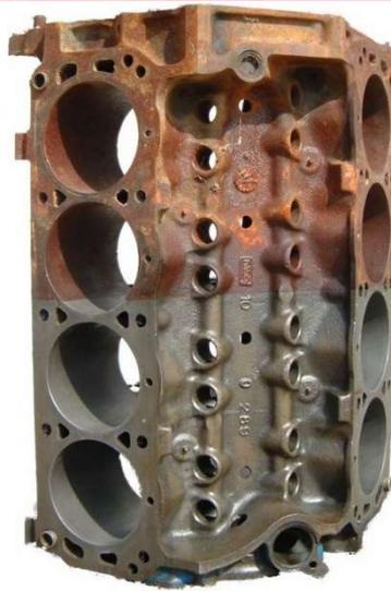
**NETTOYAGE PRELIMINAIRE :** enlèvement de la couche organique et/ou inorganique superficielle éventuelle de couverture de la couche de rouille avec détergent/dégraissant et/ou détartrant adéquat.
