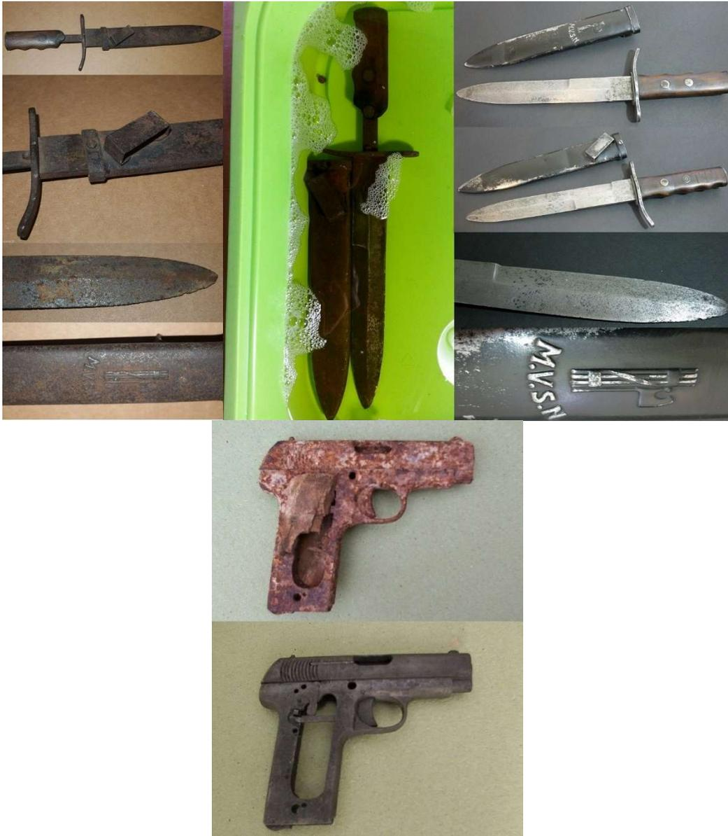
**INHIBITEUR DE L'OXYDATION** : après le traitement, il faudra rincer la pièce à l'eau avant n'importe quel autre traitement (par exemple : phosphatation, peinture, application de revêtements et/ou protecteurs, etc.).
